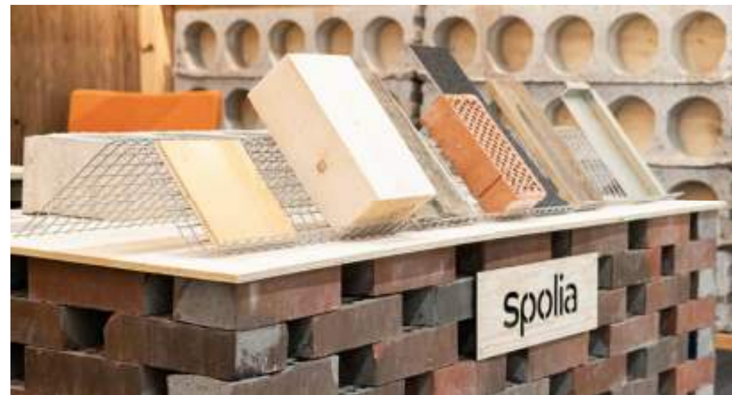
Esimerkkejä Spolian varastossa olevista uudelleenkäytettävistä rakennusosista. Kuva: Spolia Design.
